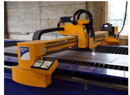
Die Anschlüsse werden vom abgewickelten Blech mit der Plasmaschneidmaschine herausgeschnitten
