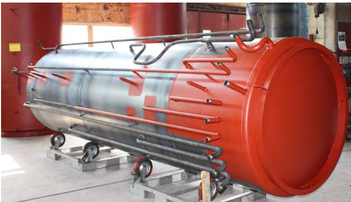
In Arbeit: Solarspeicher mit angeschweisster Verrohrung
