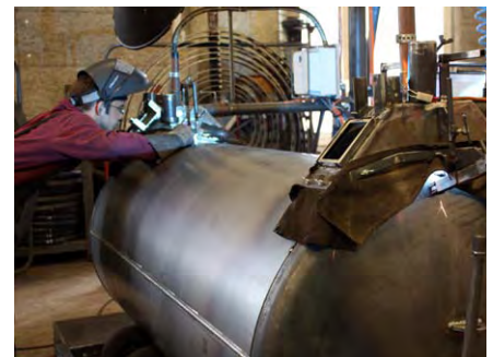
Bei Speichern ohne Einbauten werden Deckel und Böden gleichzeitig aufgeschweisst
