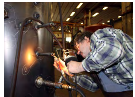
Jeder Speicher wird mit Wasser gefüllt und einer strengen Qualitätskontrolle unterzogen
