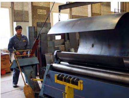
Der Speichermantel wird gerundet
