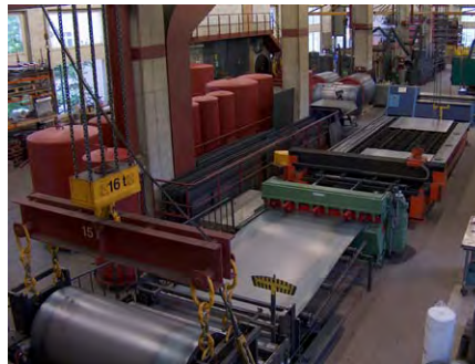
Ausgehend vom 16-Tonnen-Stahlcoil werden Speicher in Serie oder individuell produziert
