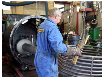
Wärmetauscher, Boiler und Stützen werden angeschweisst
