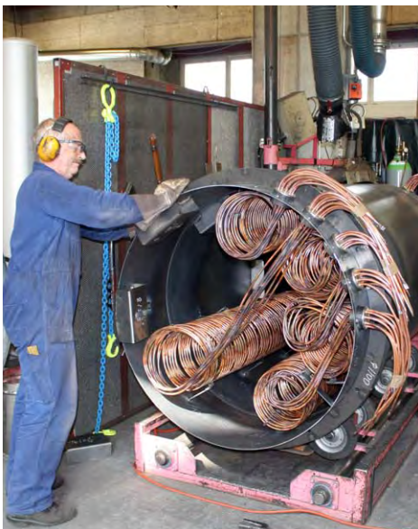
Wärmerückgewinnungs-Speicher Gewerbliche/industrielle Abwärme
