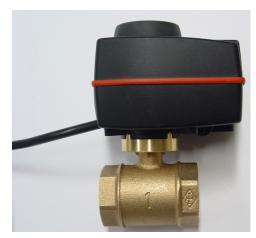
Nun bietet die Fa. Solar-Partner Süd GmbH einen elektomotorischen Antrieb für die GLOBO-Kugelhähne an. Der ESBE-Stellantrieb Typ ARA645 mit einer Stellzeit von 30 Sekunden verfügt über ein Drehmoment von 6 Nm.
