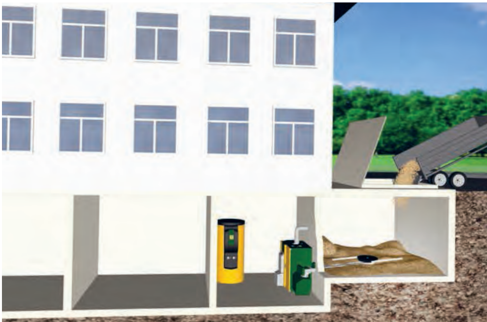
Heizung im Keller eines Gebäudes KWB Multifire mit Rührwerk und Förderschnecke; Direkte Lagerraumbefüllung mittels Kipper
