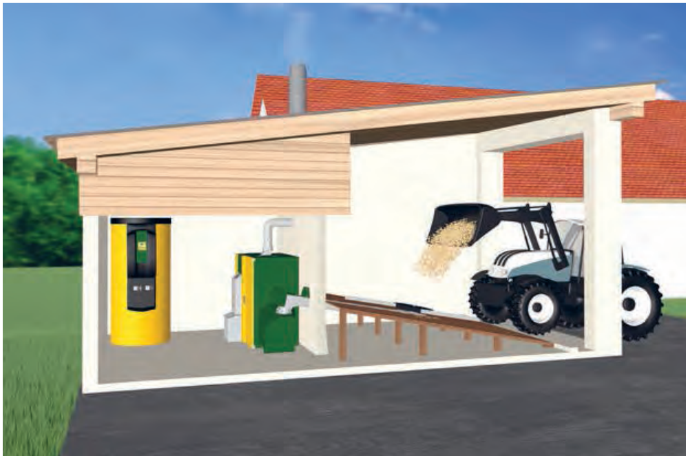
Heizung im Nebengebäude KWB Multifire mit Rührwerk und Förderschnecke; Direkte Lagerraumbefüllung mittels Traktor und Frontlader
